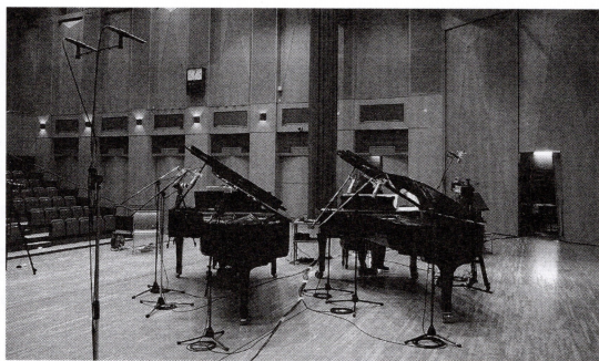
ピアノ周りのマイクセッティング。2台のピアノともそれぞれ、ノイマンU 87 Aiを2本ずつ、ピアノのローエンド側にAKG C414をセット。加えてアンビエンス用マイクを立てる
